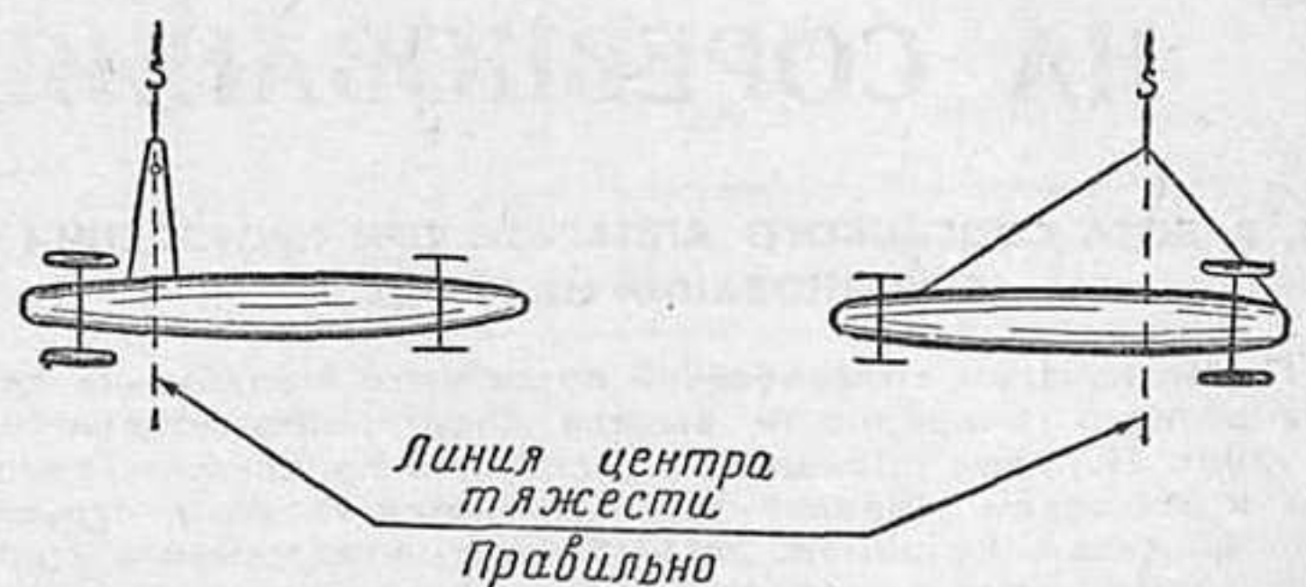
Рис. 5. Правильное крепление кордовой планки и уздечки.
